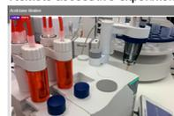
Experiment 1: Remote autotitrator for an acid-base titration.
